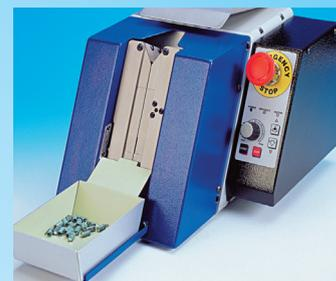
La macchina TP/TC4 è utilizzata per il taglio di componenti radiali sfusi. Velocità ed altezza di taglio sono regolabili. L'alimentazione elettrica s'interrompe quando lo sportello frontale viene rimosso dalla macchina
