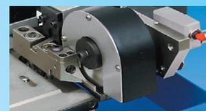
La SEP4 è una macchina idonea al taglio dei connettori strip, di facile regolazione per diverse dimensioni. Regolazione taglio con lunghezze da 1 a 32 pins. Blocco dello strip in posizione prima del taglio. Motore con regolazione velocità. Conteggio dei pezzi tagliati.
