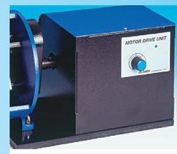
Il modello TP/IC-F serve per raddrizzare, portarndoli a passo, i reofori dei componenti integrati, per sveltire il loro assemblaggio sulle schede elettroniche. Con la macchina vengono forniti i porta stecche necessari per lavorare componenti con passo standard 7,62 mm e 15,24 mm.
