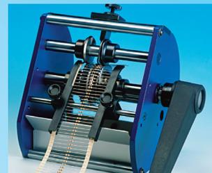
Il modello TP6/V/1-EC è utilizzato per tagliare e piegare componenti assiali nastrati per montaggio in verticale. Lavora componenti con  $\varnothing$  del reoforo da 0,5 a 0,8mm .
