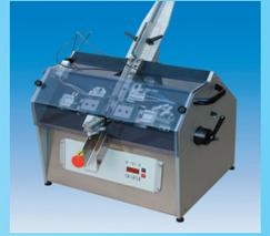
La TP/TO-CF è una macchina automatica utilizzata per eseguire il taglio e la forma di transistori in stecca (TO-220, TO-218, TO-126). Le lavorazioni vengono impostate e controllate tramite un PLC. L'operazione è completamente automatica e ciascuna forma richiede matrici dedicate. Due premi filo bloccano i reofori prima della fase di taglio e preformatura. Forme speciali possono essere realizzate su richiesta e specifiche del cliente.
