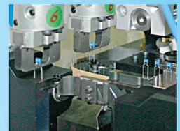
La SP27/A è una macchina pneumatica per la preparazione di componenti radiali nastri a più stazioni. A seconda della forma richiesta può effettuare diverse pieghe complesse. Lavora i componenti in automatico e li deposita in un cassetto.
