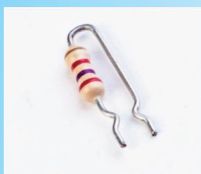
La macchina TP6/V - PR/1 è utilizzata per tagliare, piegare e formare componenti assiali per montaggio verticale. La forma realizzata serve a bloccare il componente sulla scheda. Le quote sono quasi tutte regolabili. La macchina lavora componenti con  $\varnothing$  di reoforo da 0,5 a 0,8mm. La forma realizzata è a passo 2,54 mm. Versioni speciali possono essere progettate per formare reofori di dimensioni maggiori.
