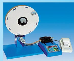
Il contapezzi digitale a microcomputer esegue il conteggio di componenti nastri assiali e radiali e componenti SMD con l'applicazione dell'apposito adattatore. Il conteggio può avvenire in entrambe le direzioni (destra e sinistra).
