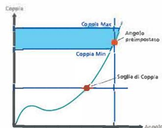
Questa modalità dà priorità all'angolo da raggiungere misurandolo a partire da una percentuale di coppia di fissaggio. A partire dalla coppia di soglia inserita il sistema inizierà a contare i gradi, e al raggiungimento dell'angolo impostato l'avvitatore si fermerà.
