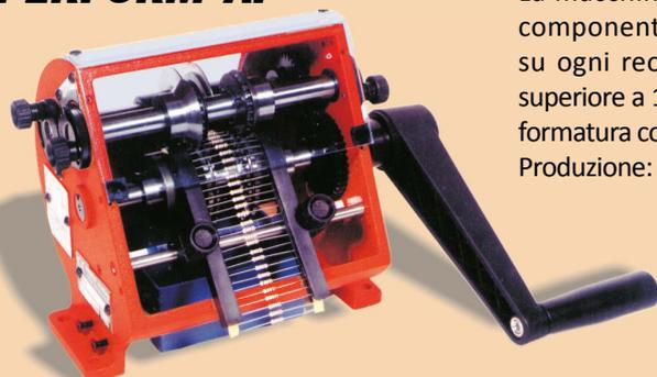
La macchina SUPERFORM/AP esegue il taglio e la piegatura dei terminali dei componenti elettronici assiali nastrati con in più la sagomatura di un ricciolo su ogni reoforo. Si possono preformare reofori con  $\varnothing$  non inferiore a 1 mm e non superiore a 1,4 mm. E' possibile escludere le due ansine sostituendo i 2 coltelli taglio/formatura con i coltelli di solo taglio (opzionali)
