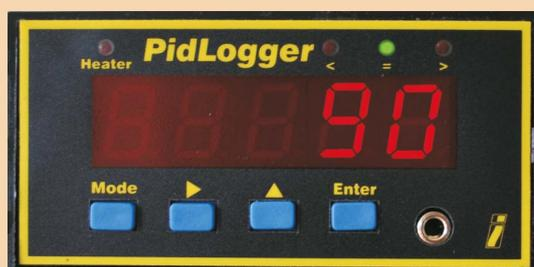
Controllo elettronico con funzioni di regolatore PID, e timer multifunzione.
