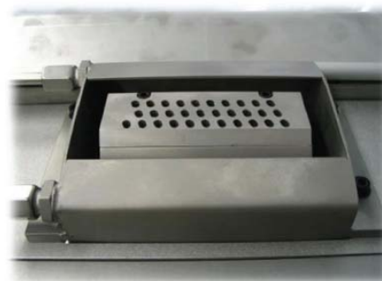
Saldatura a 0° usando i nozzle "statici"
