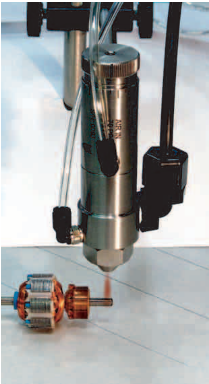
▲ TS5540 marcatura a spruzzo di un particolare metallico.
