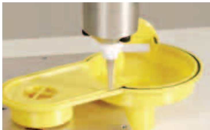
▲ TS941 deposito di guarnizione liquida
